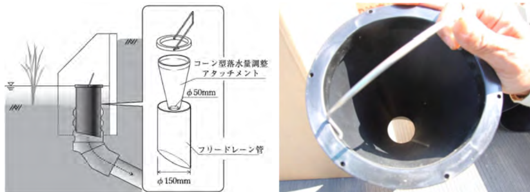
図 31 改良後の流出量調整器具（機能分離型）
