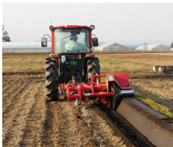
写真6 左 畦畔の再構築 右 畦畔塗り (山形県 塩野地域保全会提供)
